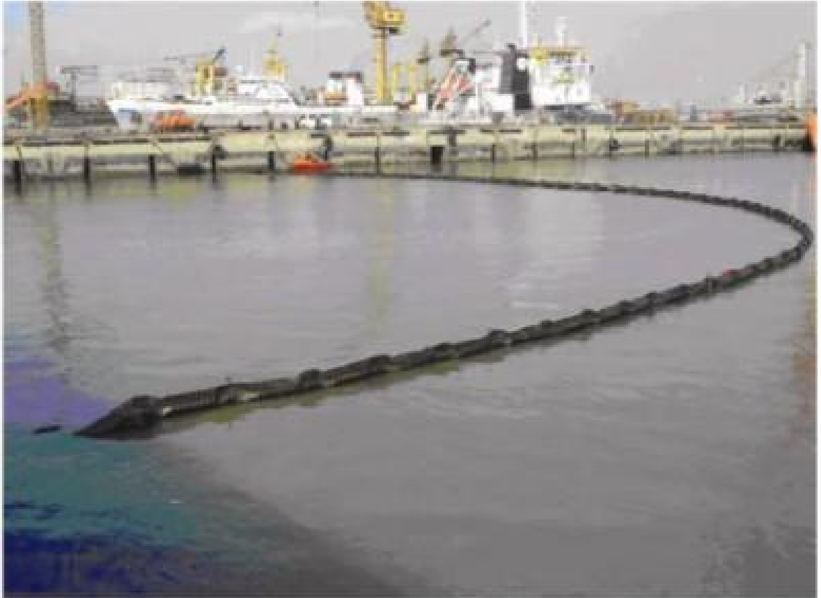
图5 港口码头围油栏的布控
