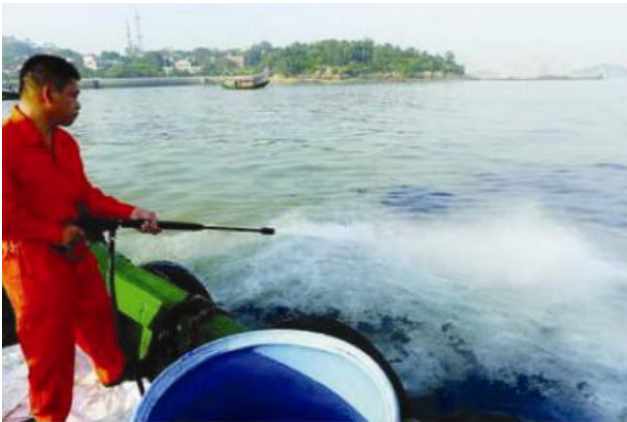
图 11 手持式溢油分散剂喷洒
