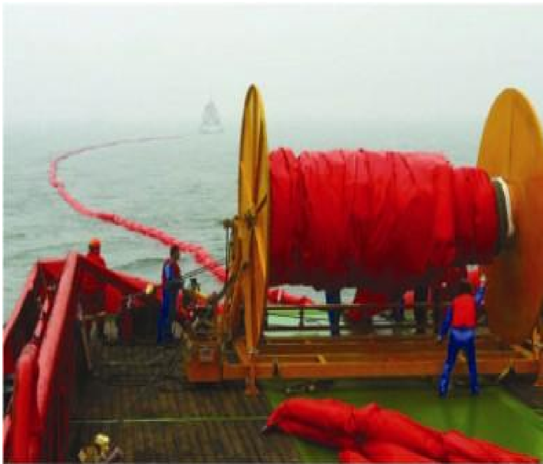
图9吸油拖栏的布放
